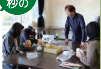
ぬいぐるみの中の綿を取り出し、成形したウレタンの中へ入れて丸みを帯びた形に整える。この時、手足が動かせるようアルミ線を装着し、背中を縫い合わせて元通りに仕立てるとこま撮り用の「ぼお」が完成
