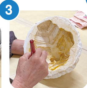
石膏を乾かした後に内側に ワックスを塗る
